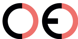
Marcatura CE contraffatta (troppo distante)
